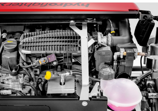
Wassergekühlter Dreizylinder-Viertakt-Ottomotor, leiser und vibrationsarmer Motorlauf, niedrige Abgastemperaturen
